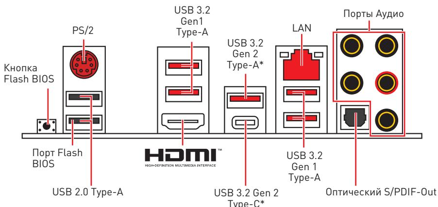
\*USB 3.2 Gen2 (AMD Ryzen™ 3-го поколения) или USB 3.2 Gen1 (AMD Ryzen™ 2-го поколения/ Ryzen™ с видеокартой Radeon™ Vega и AMD Ryzen™ 2-го поколения с видеокартой Radeon™)
