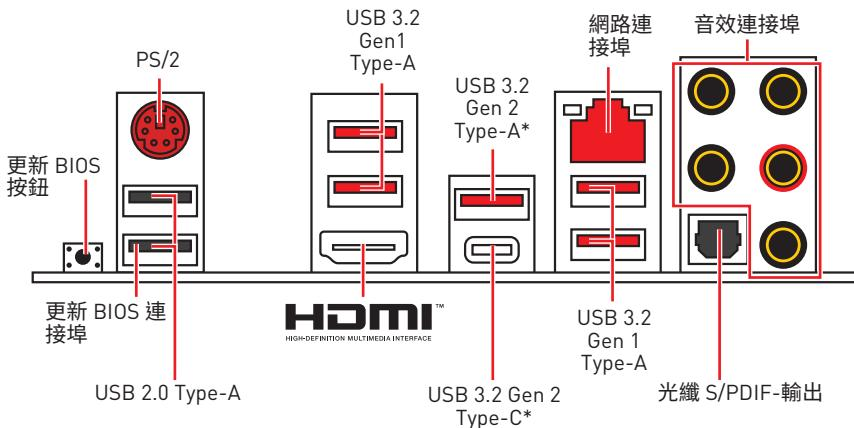
\*USB 3.2 Gen2 (安裝第三代 AMD Ryzen™ 時) 或 USB 3.2 Gen1 (安裝第二代 AMD Ryzen™/ 搭載 Radeon™ Vega 顯示晶片的 Ryzen™ 及搭載 Radeon™ 顯示晶片的第二代 AMD Ryzen™ 處理器時)
