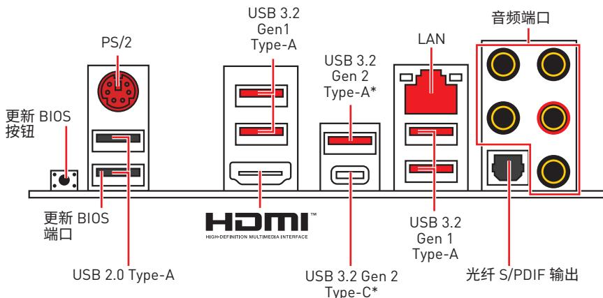
\*USB 3.2 Gen2 (第三代 AMD 锐龙™) 或 USB 3.2 Gen1 (第二代 AMD 锐龙™/ 搭载 Radeon™ Vega Graphics 的锐龙™ 和搭载 Radeon™ Graphics 的第二代 AMD 锐龙™)
