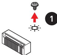
2. ユーザーのニーズによって、同梱のヒートシンクのスタンドオフ [6#23あるいはM3]を選択し、取り付けスタンドに固定します。
