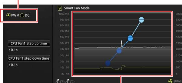
ファンスピードの傾斜ポイントはCPUの温度との関連のファンスピードを調整します。
