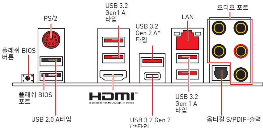
\*USB 3.2 Gen2 (3세대 AMD Ryzen™) 또는 USB 3.2 Gen1 (2세대 AMD Ryzen™ / Radeon™ 베가 그래픽 내장된 Ryzen™ 및 Radeon™ 그래픽 내장된 2세대 AMD Ryzen™ 프로세서)
