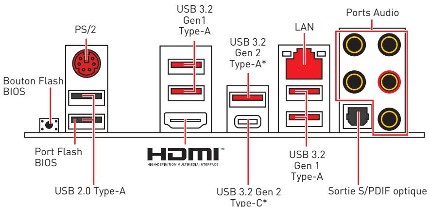
\*USB 3.2 Gen2 (AMD Ryzen™ de 3ème génération) ou USB 3.2 Gen1 (AMD Ryzen™ de 2ème génération/ Ryzen™ avec coeurs graphiques Radeon™ Vega/ AMD Ryzen™ avec coeurs graphiques Radeon™ de 2ème génération)
