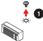
2. Wählen Sie einen Kühlkörper-Abstandshalter (# 23 oder M3), der mit dem Motherboard-Paket geliefert wurde und befestigen Sie ihn an der Motherboard-Befestigungsbohrung.
