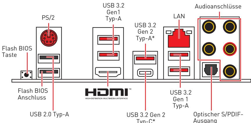
\*USB 3.2 Gen2 (AMD Ryzen™ der 3. Generation Prozessoren) oder USB 3.2 Gen1 (AMD Ryzen™ der 2. Generation Prozessoren/ Ryzen™ Prozessoren mit Radeon™ Vega Grafikprozessor und AMD Ryzen™ der 2. Generation Prozessoren mit Radeon™ Grafikprozessor)
