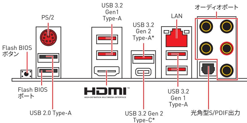
\*USB 3.2 Gen2 (第3世代AMD Ryzen™)またはUSB 3.2 Gen1 (第2世代AMD Ryzen™/Radeon™ Vega グラフィックス付きのRyzen™とRadeon™ グラフィックス付きの第2世代AMD Ryzen™)
