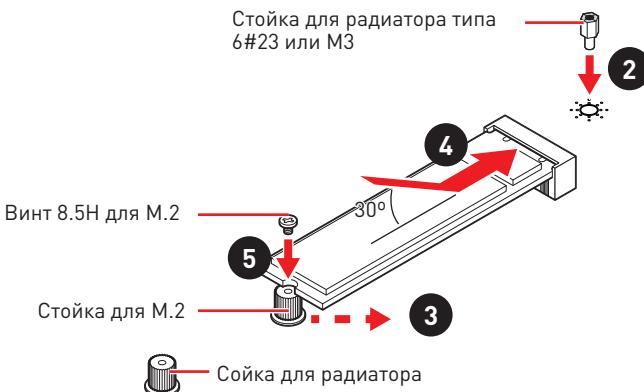
с материнской платой. Этот шаг предназначен только для установки **2242/ 2260/ 2280 M.2 SSD**.
