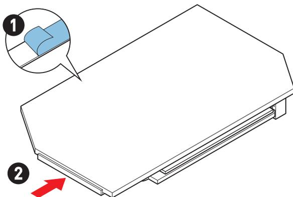
3. Soulevez légèrement l'extrémité de la plaque M.2 Shield Frozr sans vis et déplacez-la vers l'avant pour retirer la plaque.
