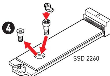
5. Insérez votre SSD M.2 dans le slot M.2 à un angle de 30 degrés.
