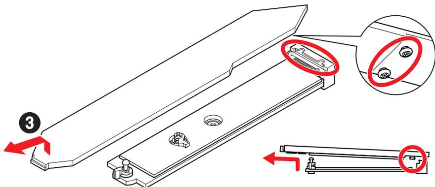
4. Retirez le film de protection et le cube en caoutchouc du pad thermique M.2 de la plaque de base.
