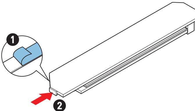
3. Heben Sie das Ende des schraublosen M.2 Shield Frozr-Kühlkörpers leicht an und bewegen Sie ihn nach vorne, um den Kühlkörper zu deinstallieren.
