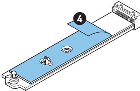
5. Entfernen oder tauschen Sie die Schrauben entsprechend Ihrer M.2-SSD-Länge aus. Überspringen Sie diesen Schritt, wenn Sie eine 2280 SSD installieren.
