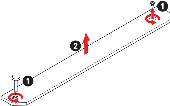
3. Wenn Sie eine 2242- oder 2260-M.2 SSD installieren möchten, installieren Sie bitte das mitgelieferte EZ M.2 Clip-Kit im 2240- oder 2260-Schraubenloch. Überspringen Sie diesen Schritt, wenn Sie eine 2280 SSD installieren.
